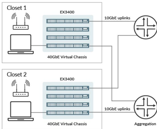
Figure 2 - Déploiements de Virtual Chassis EX3400
