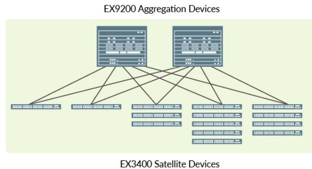
Figure 1 : Déploiement Junos Fusion Enterprise d'EX3400
